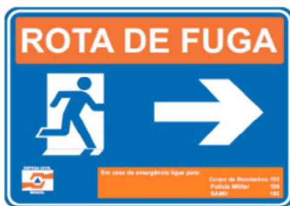
Figura 5 – Placa para rota de fuga
