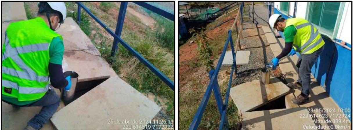
**Figura 86 - Coleta de amostras de efluentes na caixa de gordura do refeitório.**
