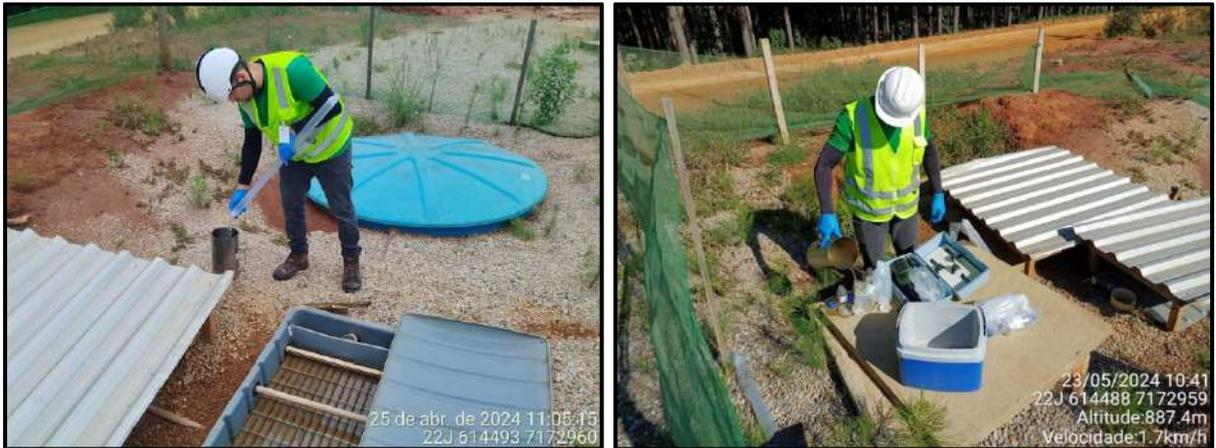
**Figura 85 - Coleta de amostras de efluentes na caixa separadora de água e óleo do posto de abastecimento.**
