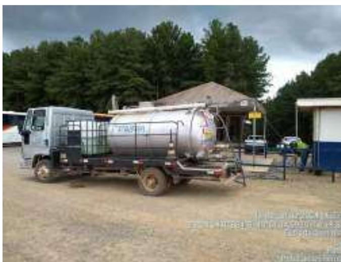
Figura 11 – Sucção da caixa coletora da portaria
