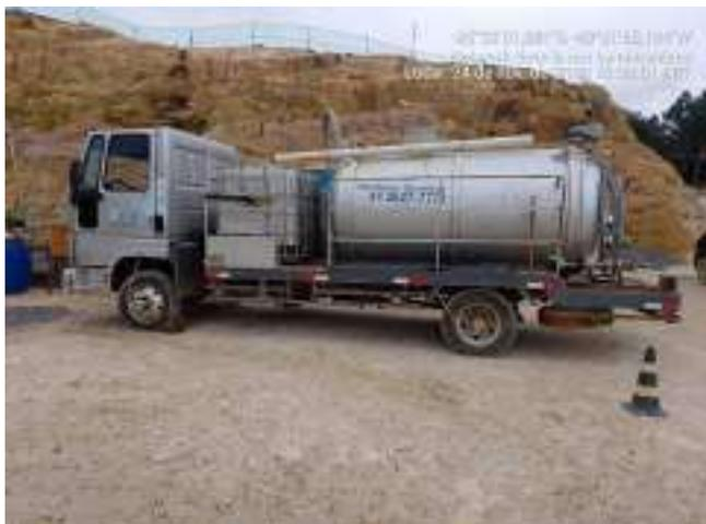
Figura 07 – Caminhão de transporte de efluentes
