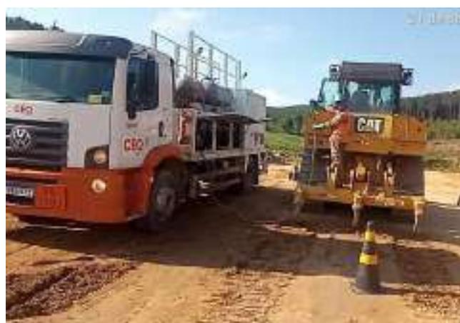
Figura 37 – Abastecimento de máquinas
