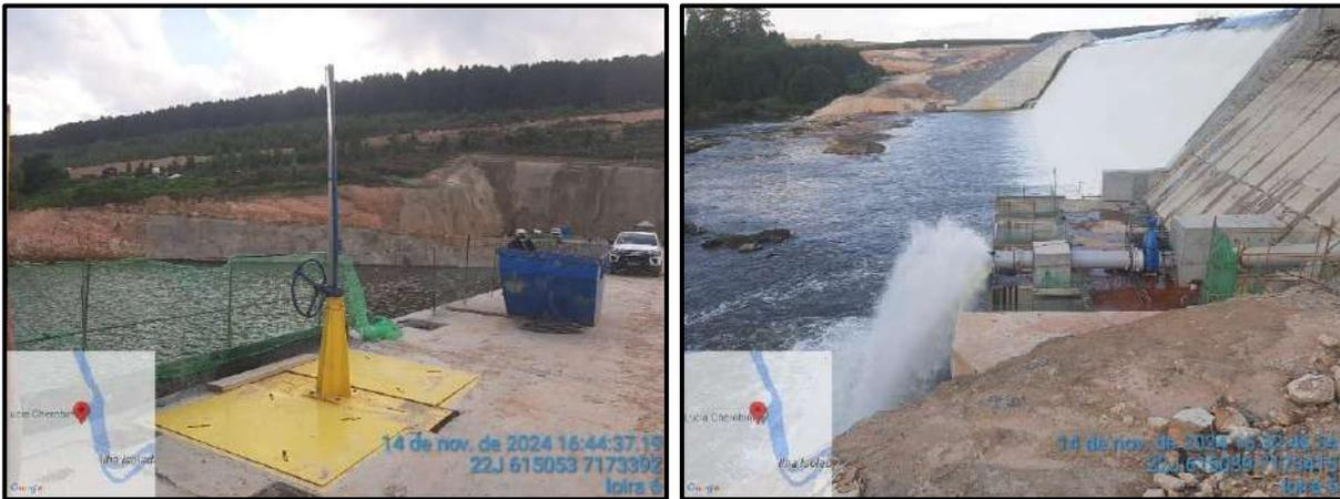
**Figura 6 – Testes de abertura do dispositivo de vazão sanitária.**
