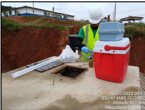
Figura 21 - Coleta de amostras de efluentes na entrada e saída do sistema da estação de tratamento de esgoto (ETE).
