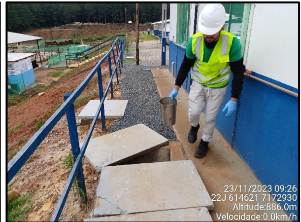
Figura 24 - Coleta de amostras de efluentes na caixa de gordura do refeitório.
