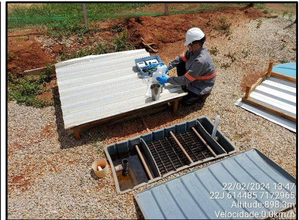
Figura 23 - Coleta de amostras de efluentes na caixa separadora de água e óleo do posto de abastecimento.
