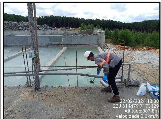
Figura 25 - Coleta de amostra de efluentes no decantador industrial.
