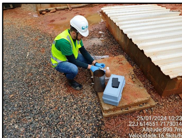
Figura 22 - Coleta de amostras de efluentes na caixa separadora de água e óleo da oficina mecânica.
