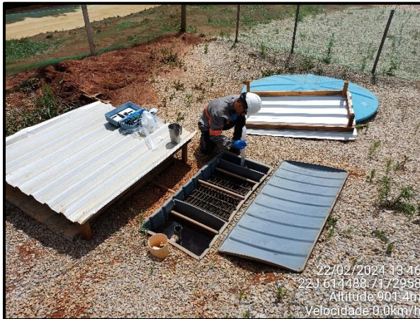
Figura 23 - Coleta de amostras de efluentes na caixa separadora de água e óleo do posto de abastecimento.
