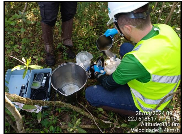
Figura 27 – Coletas de água superficial no ponto (P01- mont-res).
