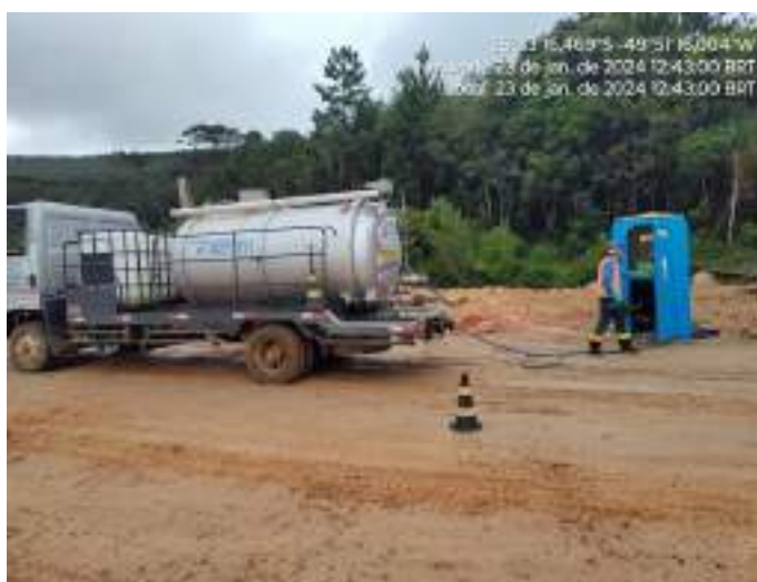
Figura 10 – Caminhão de transporte de efluentes
