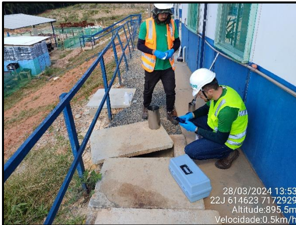
Figura 24 - Coleta de amostras de efluentes na caixa de gordura do refeitório.
