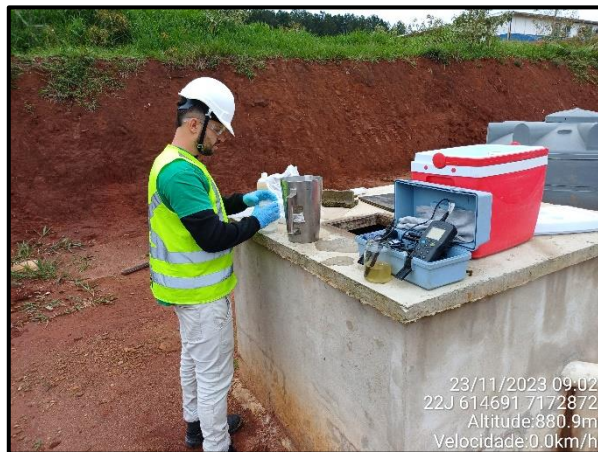
Figura 21 - Coleta de amostras de efluentes na entrada e saída do sistema da estação de tratamento de esgoto (ETE).
