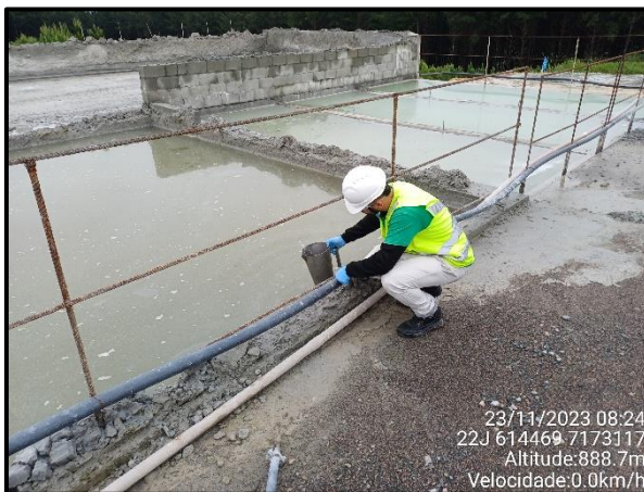
Figura 25 - Coleta de amostra de efluentes no decantador industrial.
