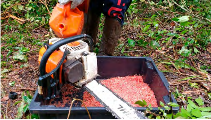
Foto 9 Abastecimento e manutenção de motosserras em bacia de retenção com material absorvente.
