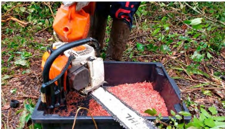
Foto 2 Abastecimento e manutenção de motosserras em bacia de contenção com material absorvente.
